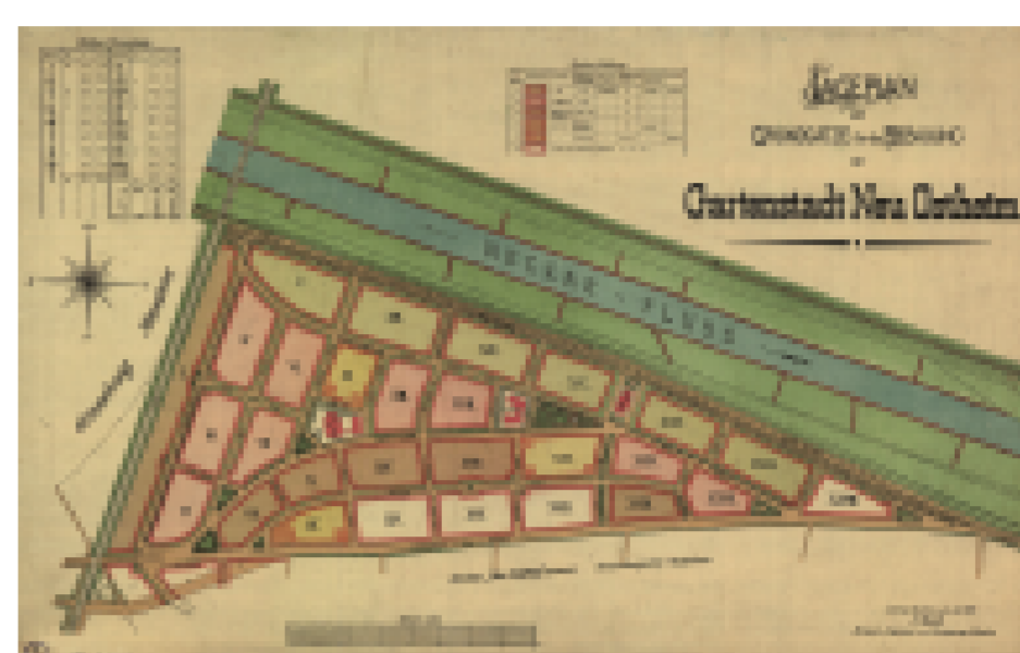
1906 lässt die Süddeutsche Diskontogesellschaft diesen Lageplan von „Privatgeometer“ Johannes Raisch zeichnen. Der Plan für das 380 000 qm große Gebiet unterscheidet zwischen offener, halboffener und geschlossener Bauweise.
